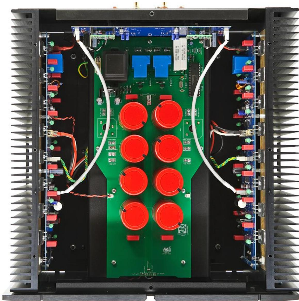
Der Leistungstransformator ist nicht nur abgeschirmt, sondern auch unter einer Eisenabdeckung montiert, was die Störunterdrückung weiter erhöht. Die gesamte Filterbank und die Gleichrichterdiode sind stattdessen ohne Luftverkabelung auf einer Leiterplatte mit 70 Mikron Kupfer montiert.
