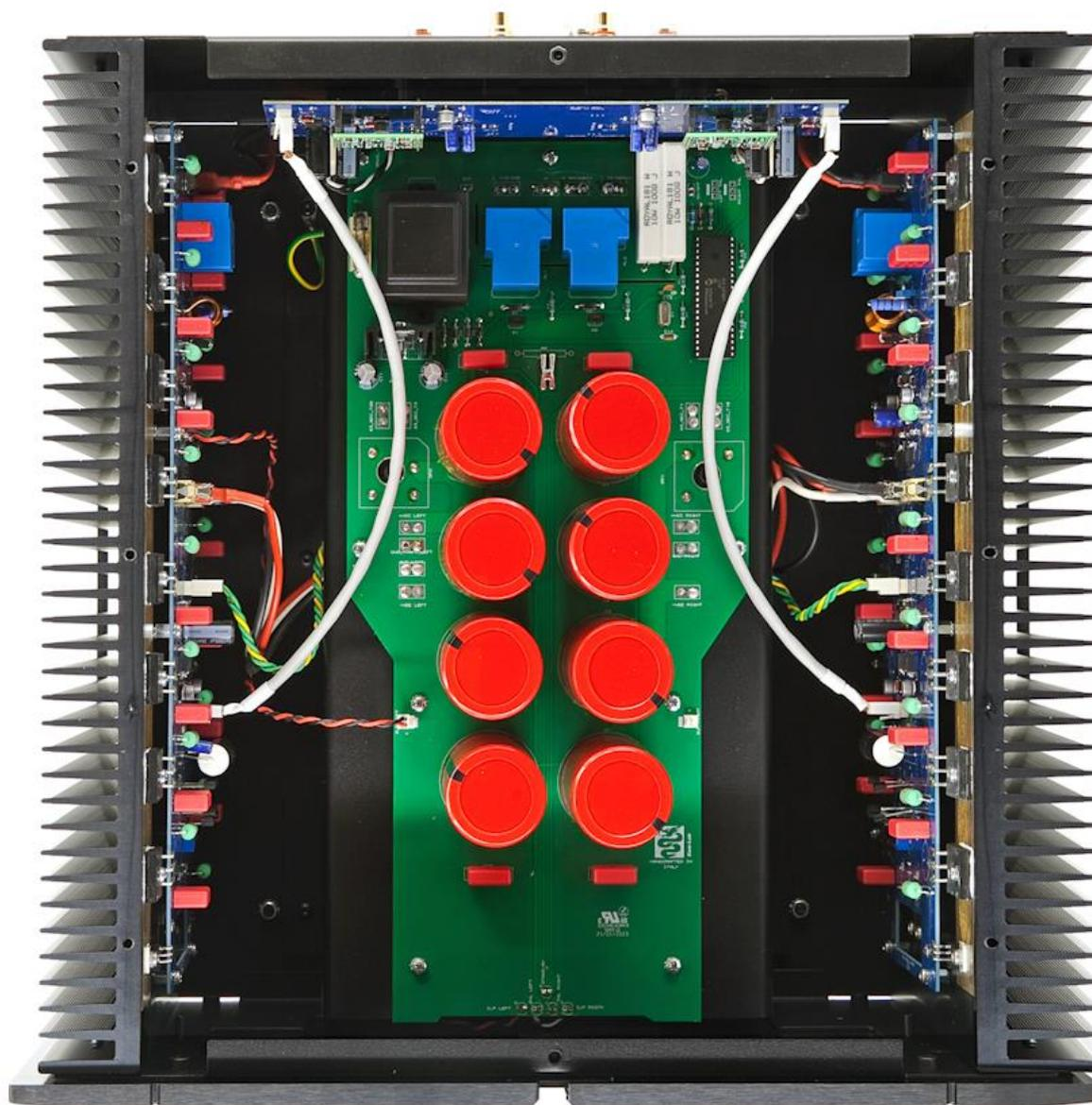
Il trasformatore di potenza , oltre ad essere schermato , lo montiamo al di sotto di una copertura in ferro che ne aumenta maggiormente la reiezione ai disturbi. Tutto il banco di filtraggio ed i diodi raddrizzatori sono invece montati su una PCB con rame da 70 micron senza cablaggio in aria.
